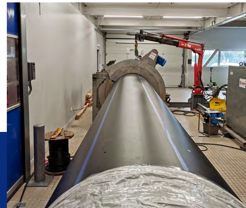
Tuyaux en polyéthylène haute densité qui remplaceront, sur les EPR2, les galeries béton enterrées du circuit d'eau brute secourue.
