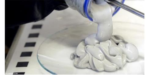
*Les chercheurs de l'Institut Fraunhofer pour les technologies de fabrication et les matériaux avancés, à Dresde (Allemagne), ont développé une pâte pour le stockage de l'hydrogène. Elle pourrait, à terme, remplacer les réservoirs et alimenter les véhicules à pile à combustible.*
