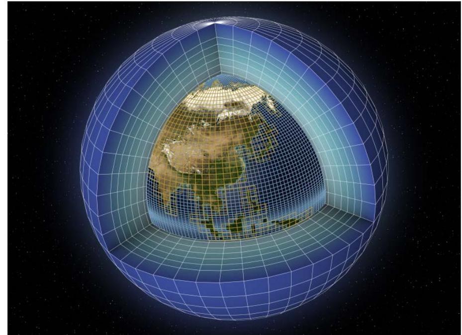
Les modèles offrent une représentation 3D de l'atmosphère, de l'océan, des glaces de mer et surfaces continentales (couplages de différents modèles) et des couplages entre le climat et le cycle du carbone, les aérosols et l'usage des terres. Ils permettent de reproduire les conditions climatiques et les tendances de température observées à l'échelle des continents sur plusieurs décennies
